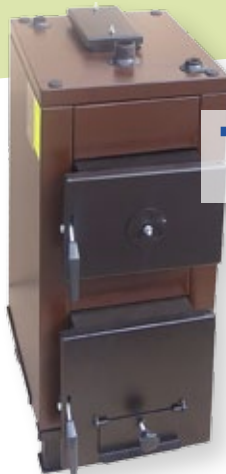
OGRZEWACZ Z PŁASZCZEM WODNYM PSB ISKIERKA 7,5 kW korpus wewnętrzny ogrzewacza z blachy 5 mm, płaszcz wodny 3,5 mm, sprawność cieplna 81,1%
